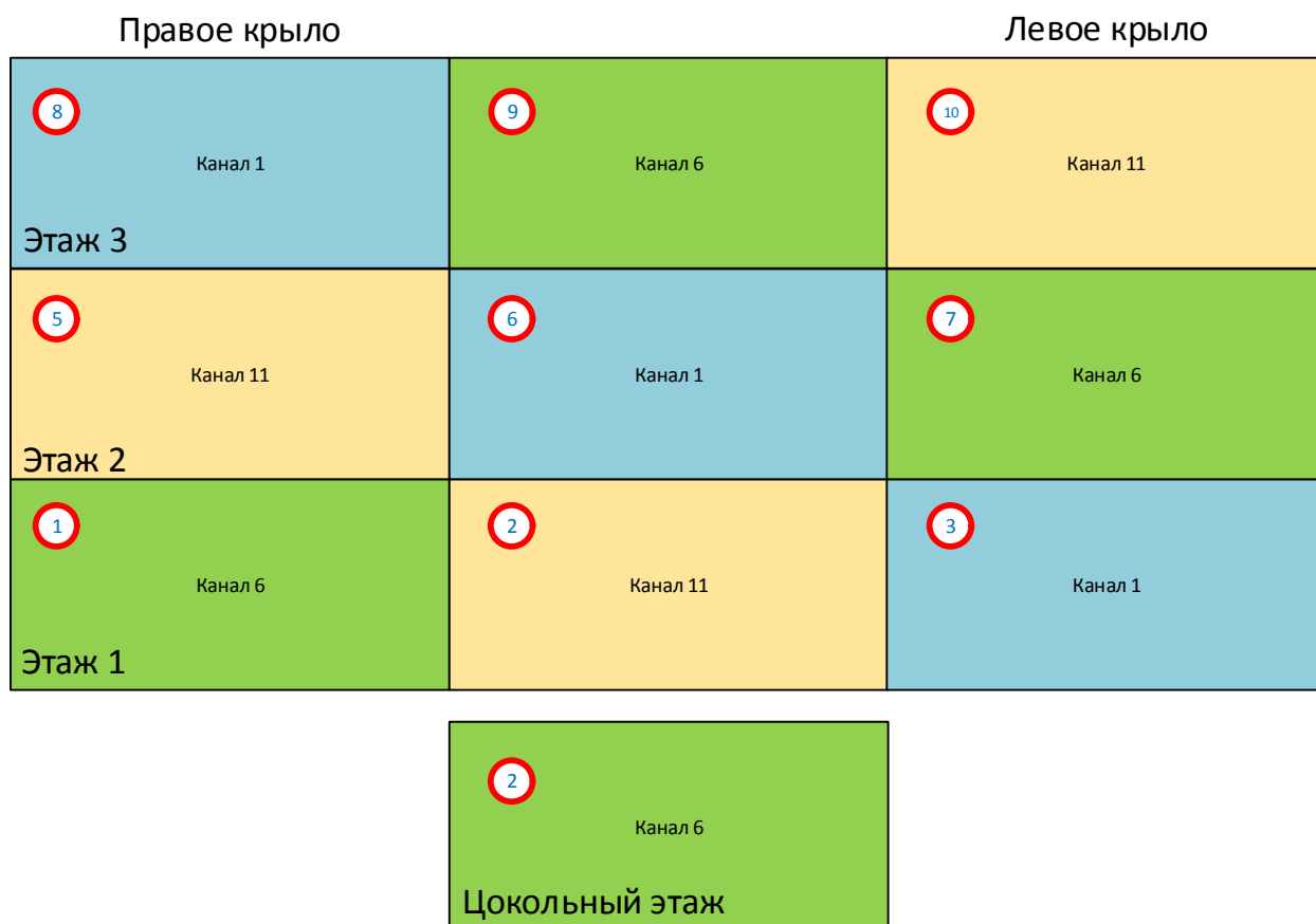
Рисунок 9 - распределение радиочастотных каналов
